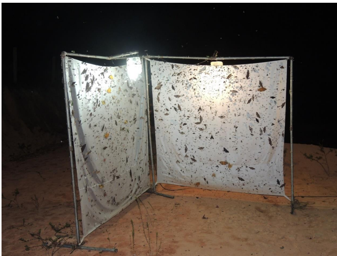
FIGURA 2 - Armadilha luminosa modelo “pano iluminado em L”. (Fonte: Teston (2025a)).
