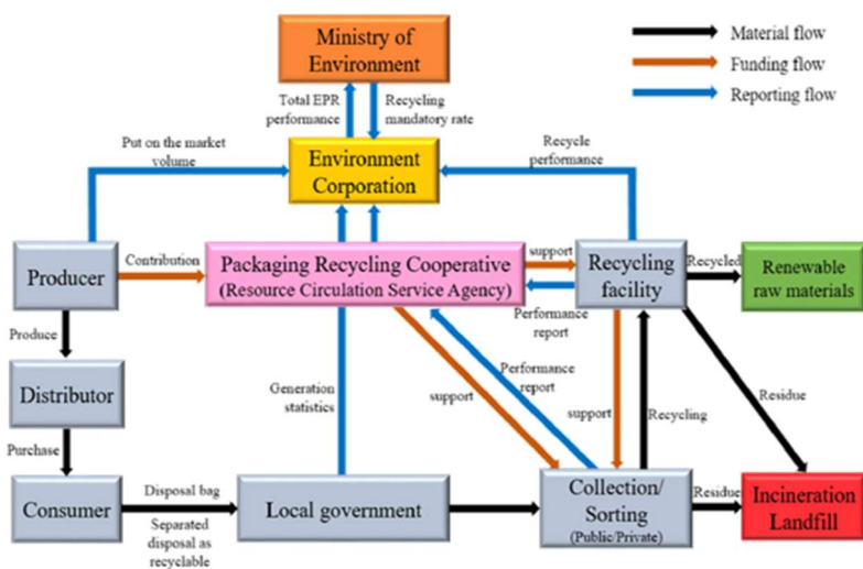
Figura 3. Sistema de reciclaje de residuos de envases de EPR en Corea del Sur. Figure 3. EPR packaging waste recycling system in South Korea.
